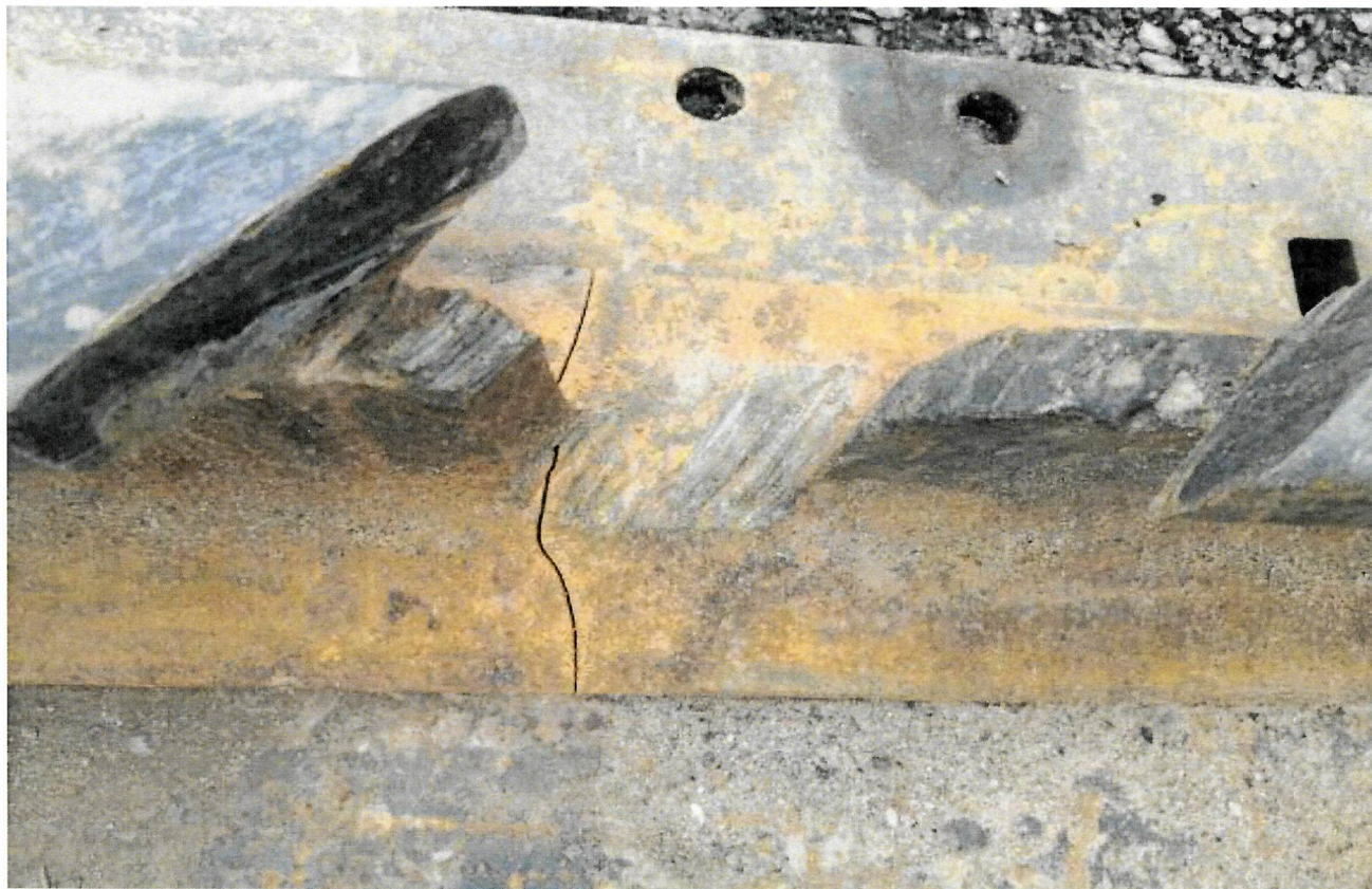
Фото №7. Остродефектный рельс. Визуально обнаруживаемая трещина в подошве.
