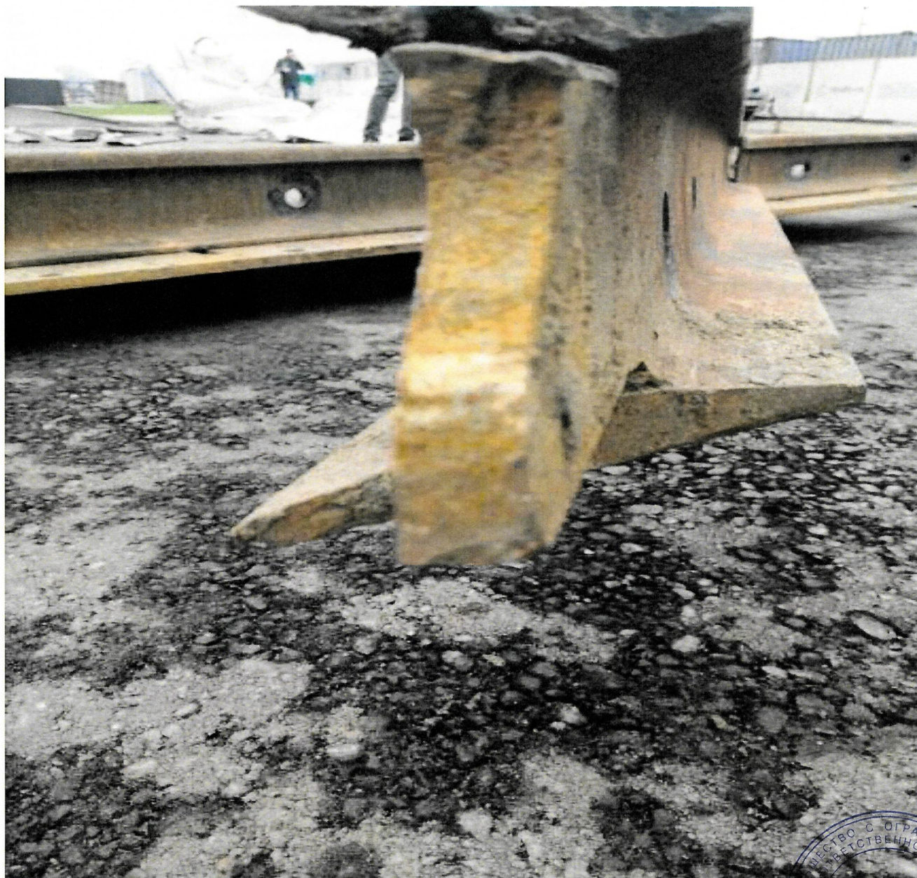
Фото №4 излома рельса в конструкции глухого пересечения:
