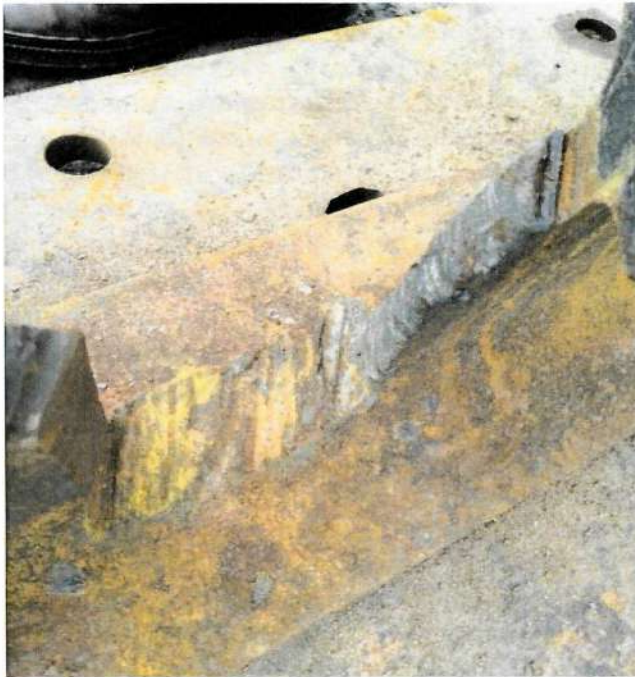
Фото №14. В конструкции «Глухое пересечение» использованы стыковые накладки распиленные пополам и затем приваренные под углом с использованием сварки.
