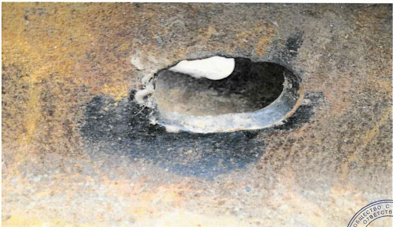
Фото №5. Остродефектный рельс. Отверстия в рельсах выполненные газоплазменным способом.
