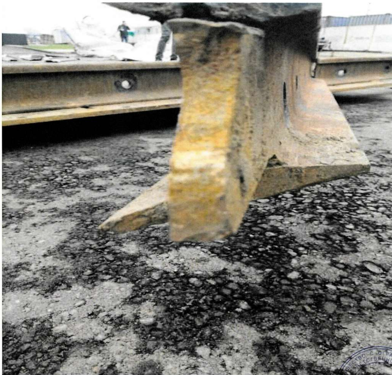
Фото №4 излома рельса в конструкции глухого пересечения:
