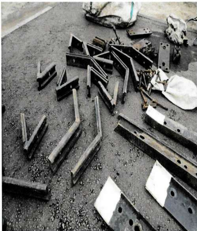
Фото №14. В конструкции «Глухое пересечение» использованы стыковые накладки распиленные пополам и затем приваренные под углом с использованием сварки.
