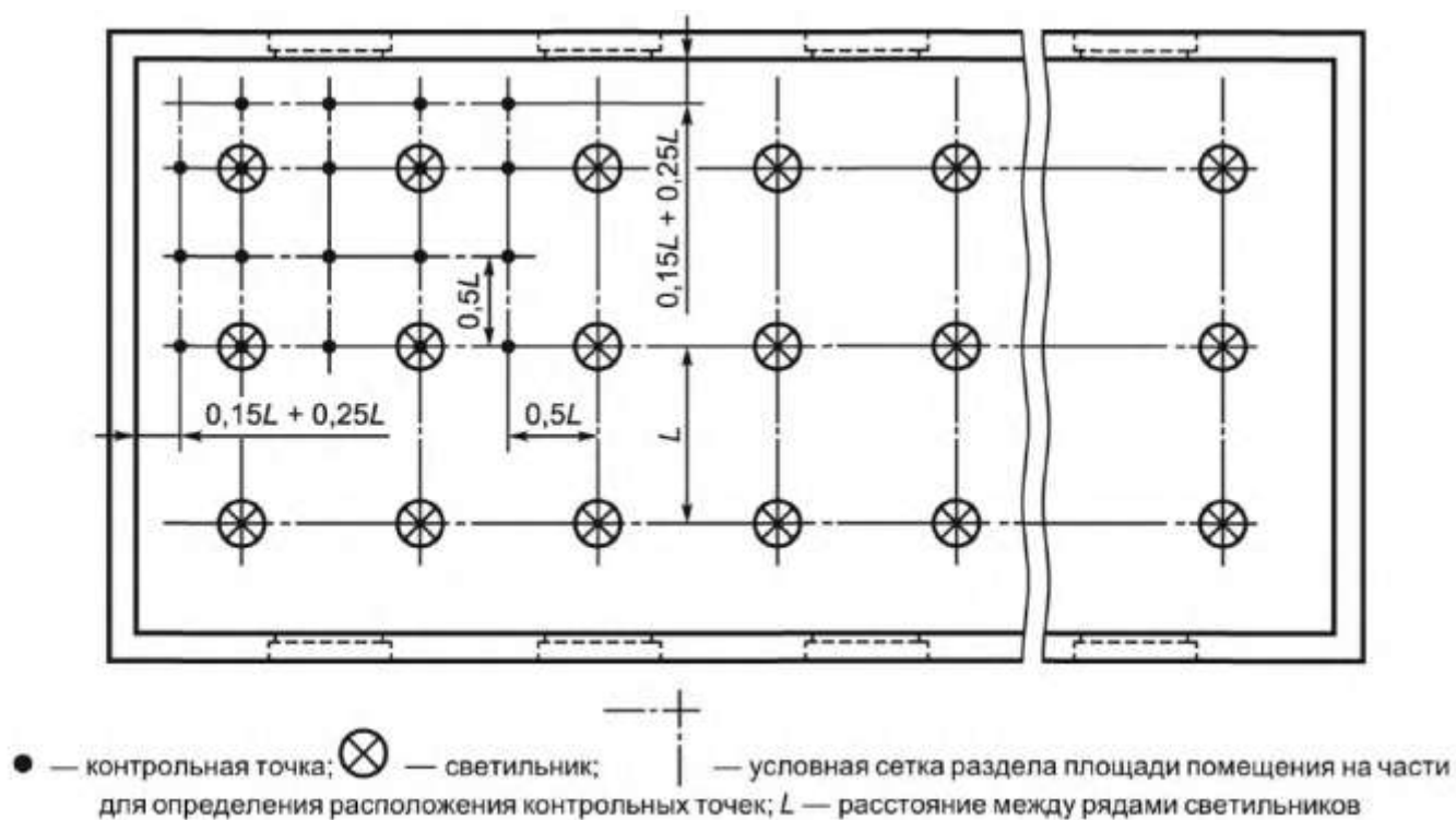
Рисунок 6.17.2. Расположение контрольных точек при измерении минимальной освещенности помещения от светильников, принимаемых за точечные излучатели
