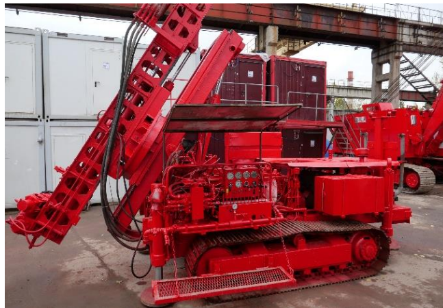
Буровая установка Hausherr HBM-15
