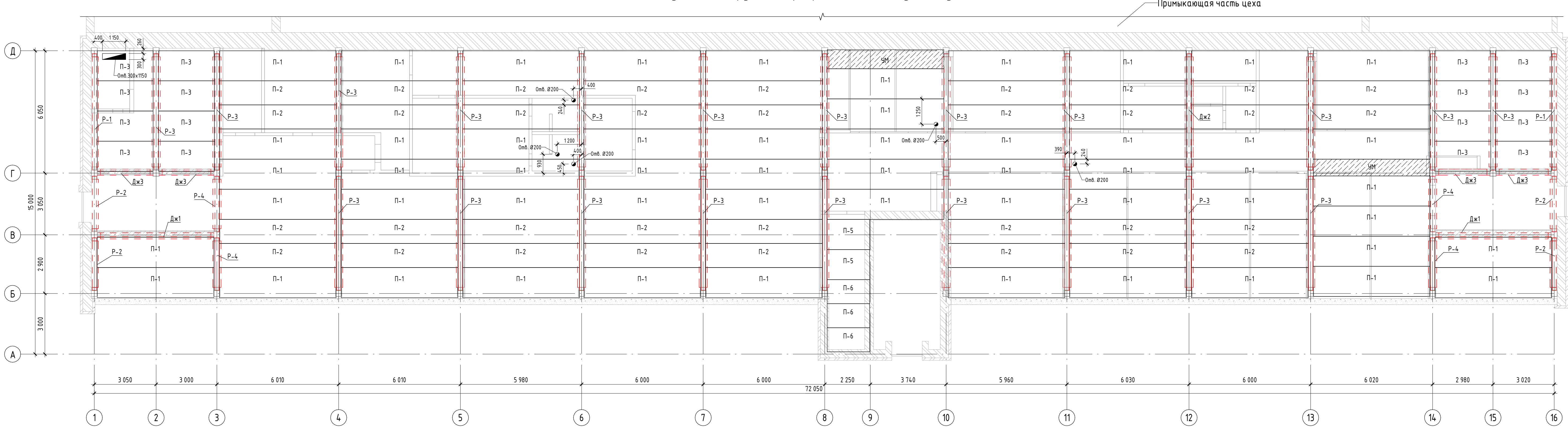
План несущих конструкций перекрытия 2 этаж (существующее положение)
