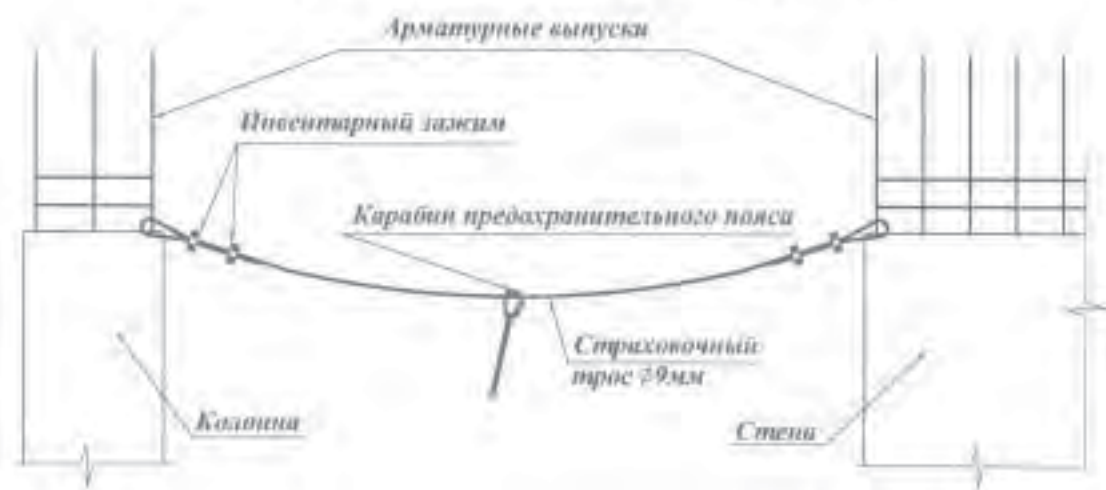
Схема крепления карабина предохранительного пояса к арматурным выпускам колонн и стен
