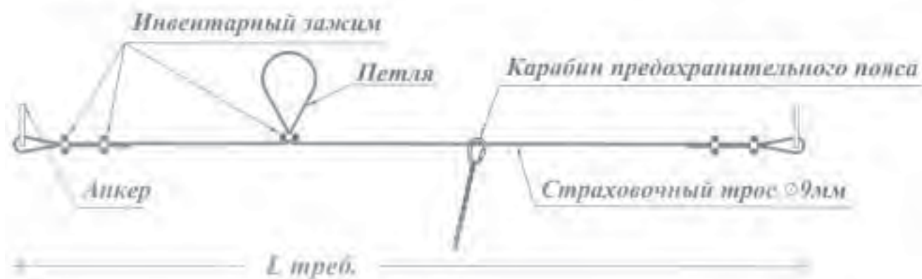
Схема крепления карабина предохранительного пояса к арматурным выпускам колонн и стен
