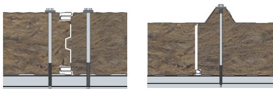
Виды профилирования поверхностей сетновых и кровельных МВ панелей:
