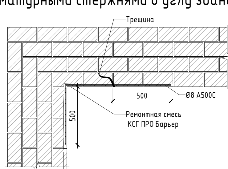
Типовой узел усиления кирпичной кладки арматурными стержнями в углу здания
