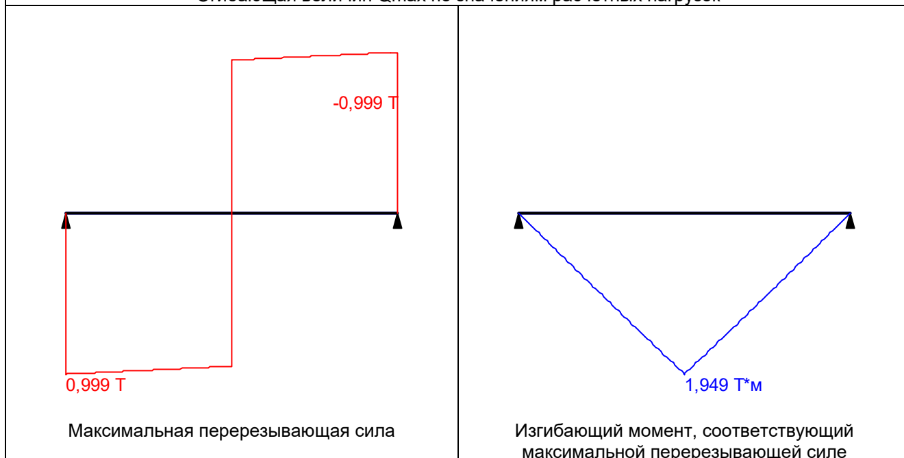
Огибающая величин Q_{\max} по значениям расчетных нагрузок
