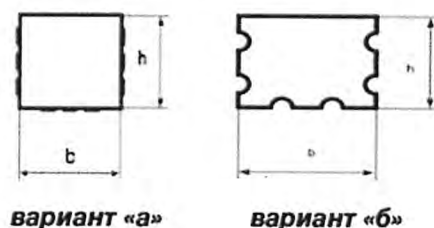
Рисунок 1 – поперечное сечение шпал.
