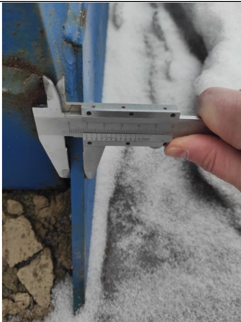
Фото 7. Измерение толщины траверсы (колонна К-2).
