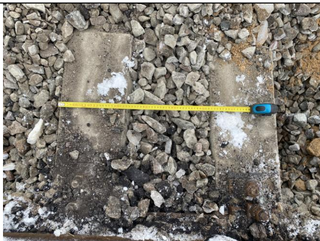
Фото 11. Измерение шага ж/б шпал (шурф 1).
