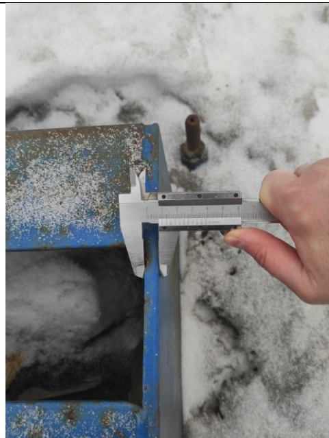
Фото 6. Измерение толщины пластины консоли колонны К-2.
