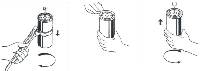
Рисунок 24. Последовательность операций при замене фильтра масляного
