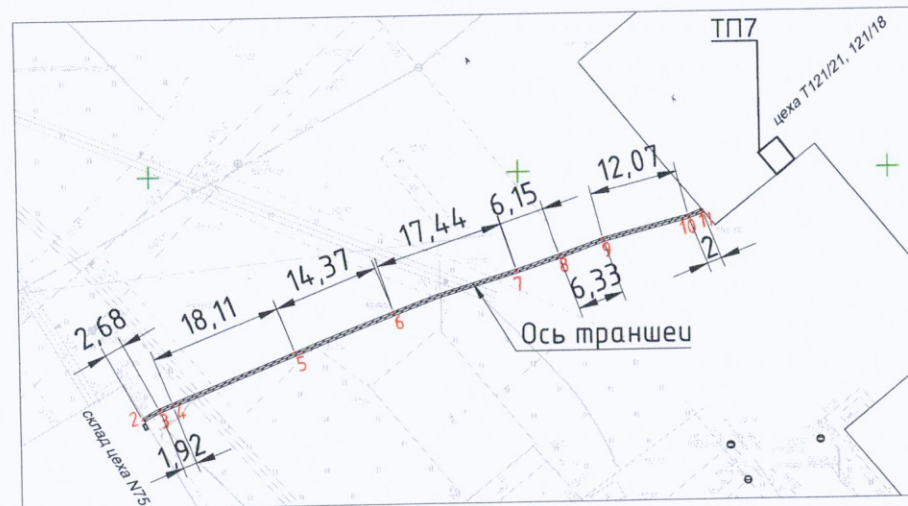
План участка производства земляных работ М 1:1000
