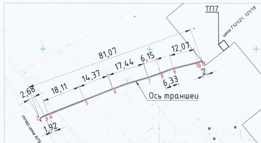
План участка производства земляных работ М 1:1000
