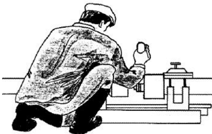
Рис.11. Снятие наружной фаски с гладкого конца трубы.
