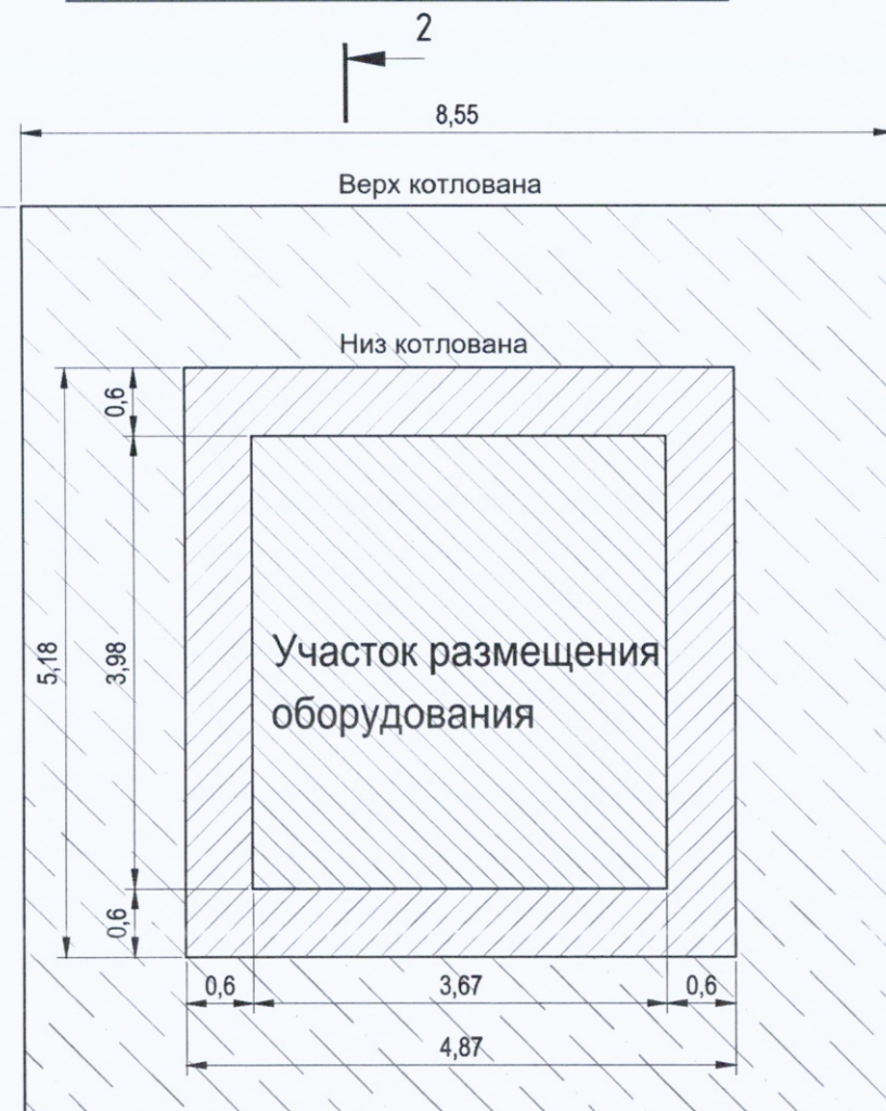
План котлована камеры В1-30 (повернуто)
