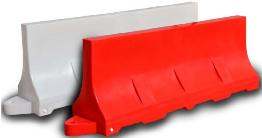
Временное ограждение из водоналивных блоков для организации работ по демонтажу существующих площадок, проездов и благоустройства (Тип 2)
