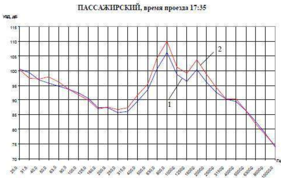
Рис.8. Измерение УЗД от рельса со вставкой (1) и без вставки (2), при проезде пассажирского поезда
