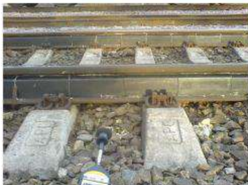
Рис.4. Общий вид шумомера «Октава», расположенного на участке с установленной вставкой
