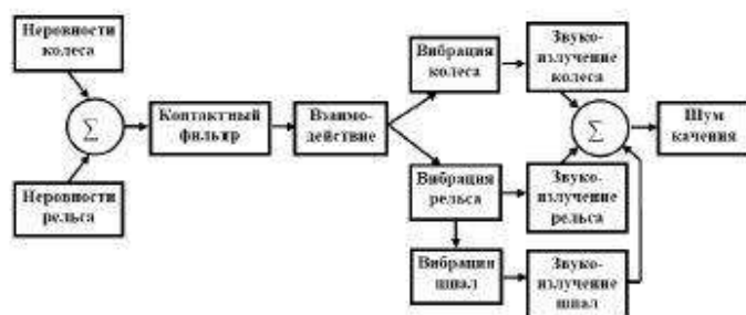
Рис. 4. Графический вид модели процесса образования шума качения
