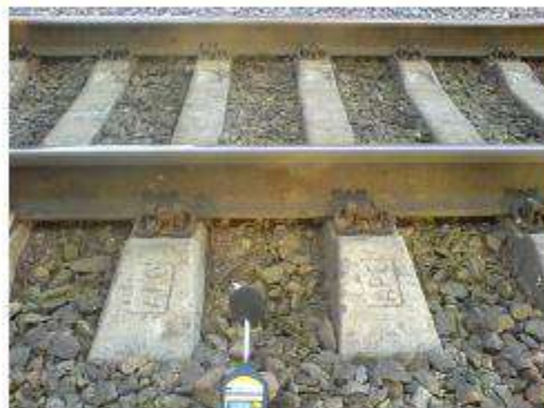
Рис.5. Общий вид шумомера «Октава», расположенного на участке без установленной вставки
