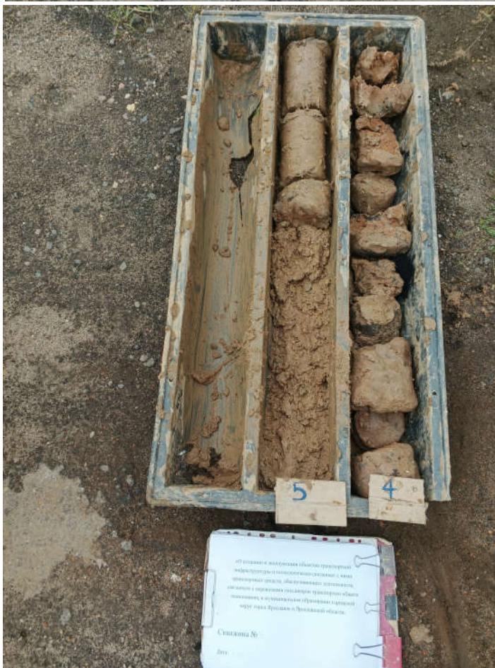
Инженерно-геологическая выкладка на скважине №8
