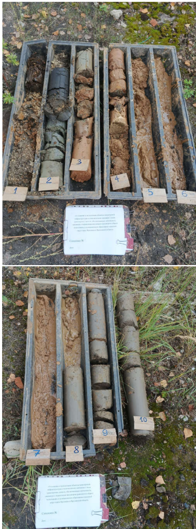
Инженерно-геологическая выкладка на скважине №1
