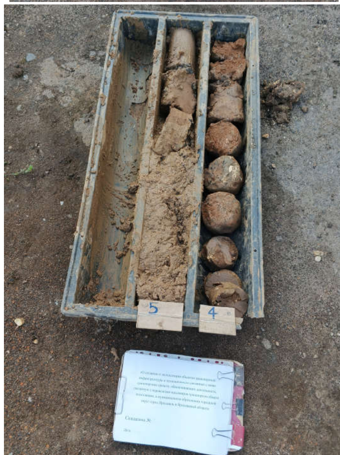
Инженерно-геологическая выкладка на скважине №5
