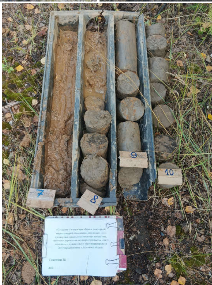
Инженерно-геологическая выкладка на скважине №4
