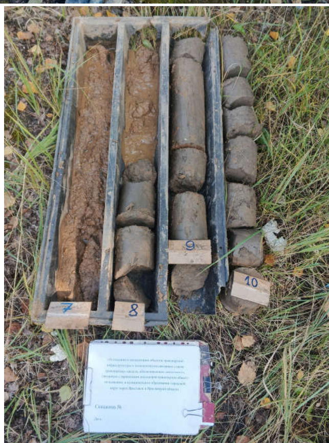
Инженерно-геологическая выкладка на скважине №3
