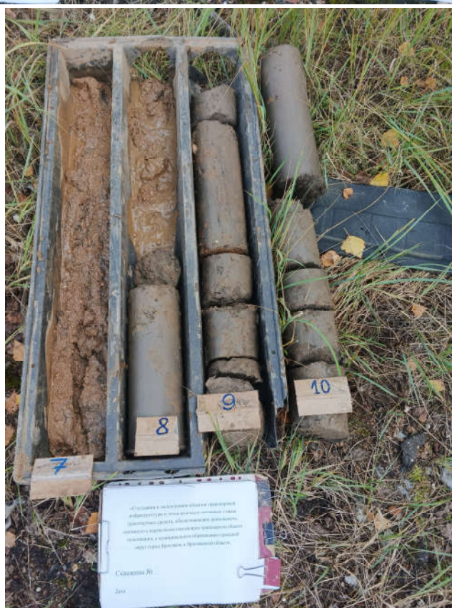
Инженерно-геологическая выкладка на скважине №2
