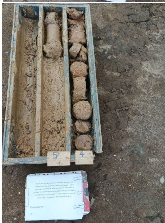
Инженерно-геологическая выкладка на скважине №6
