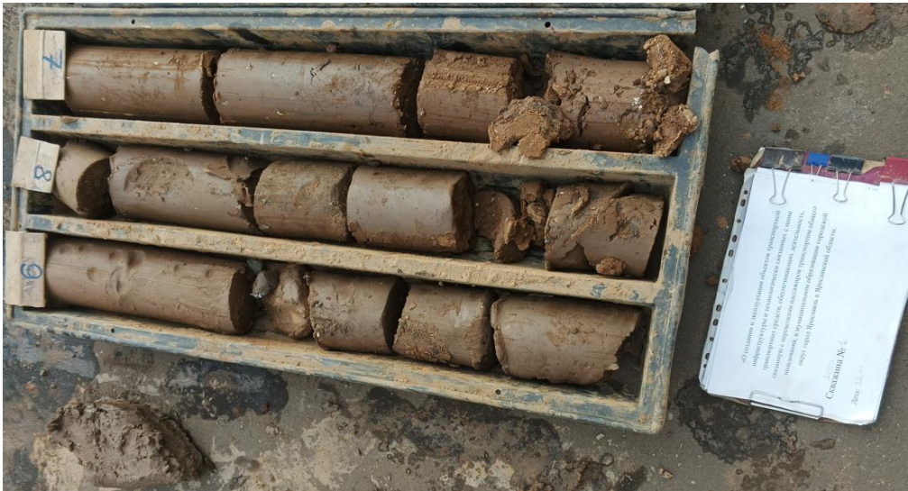
Фото 2. Выкладка монолитов (с 7 по 9 м), скважина 1
