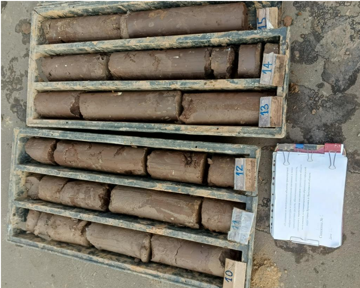
Фото 3. Выкладка монолитов (с 10 по 15 м), скважина 1
