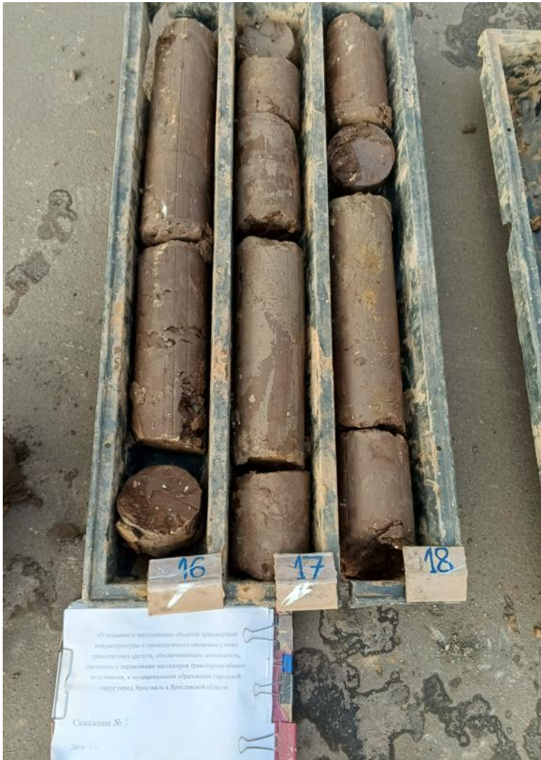
Фото 4. Выкладка монолитов (с 16 по 18 м), скважина 1
