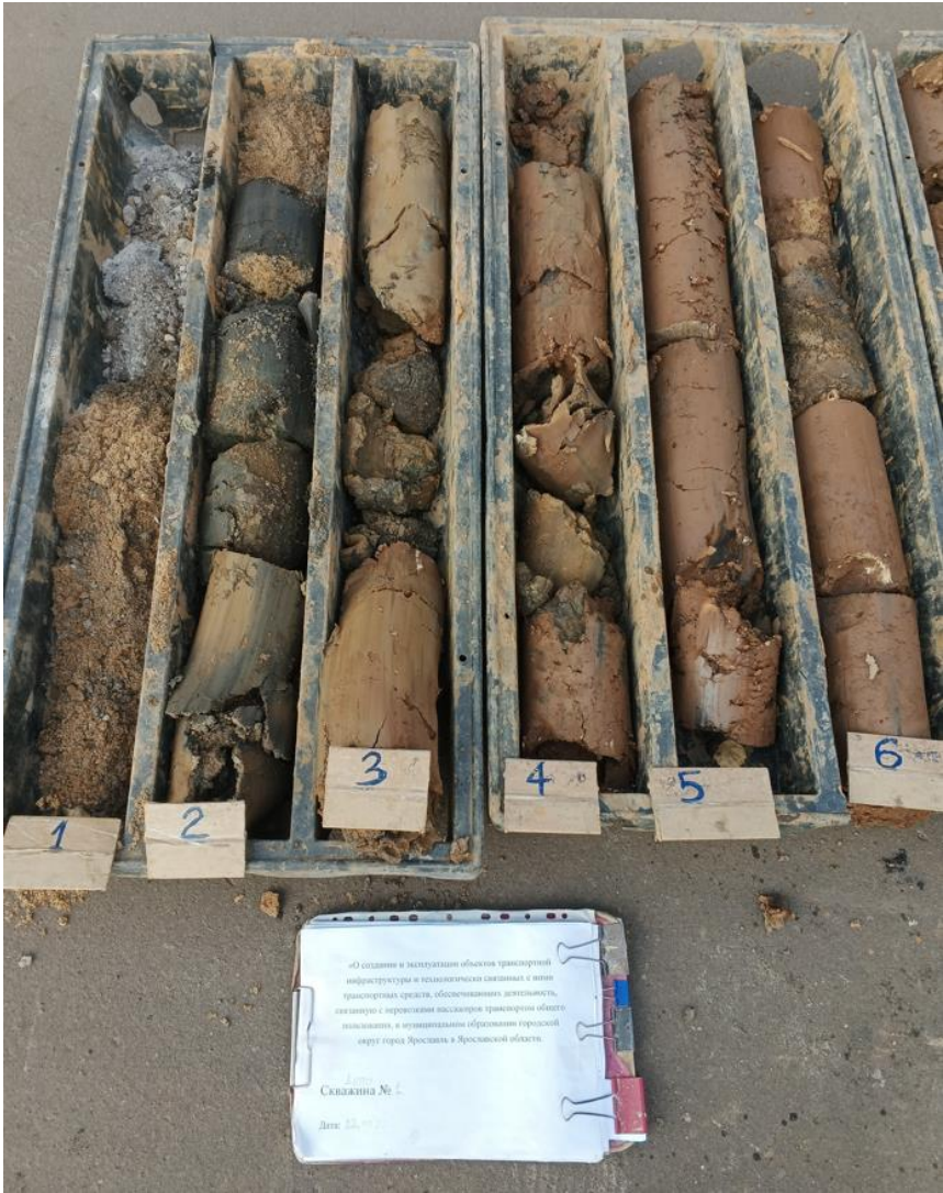
Фото 1. Выкладка монолитов (с 1 по 6 м), скважина 1
