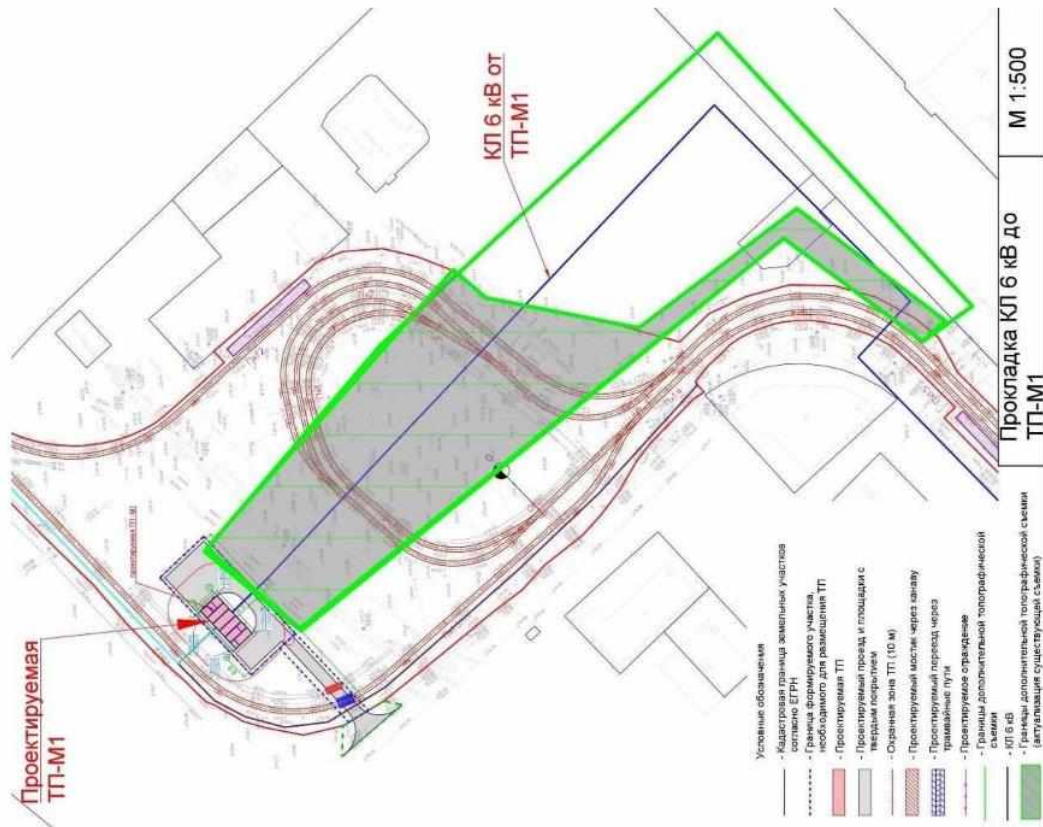
Рисунок 4.2 Обзорная схема расположения кабельных линий 6 кВ до ТП-М1
