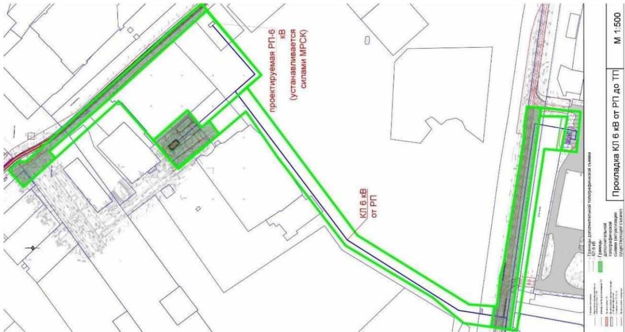
Рисунок 4.2 Обзорная схема расположения кабельных линий 6 кВ до ТП-М4 и от РП
