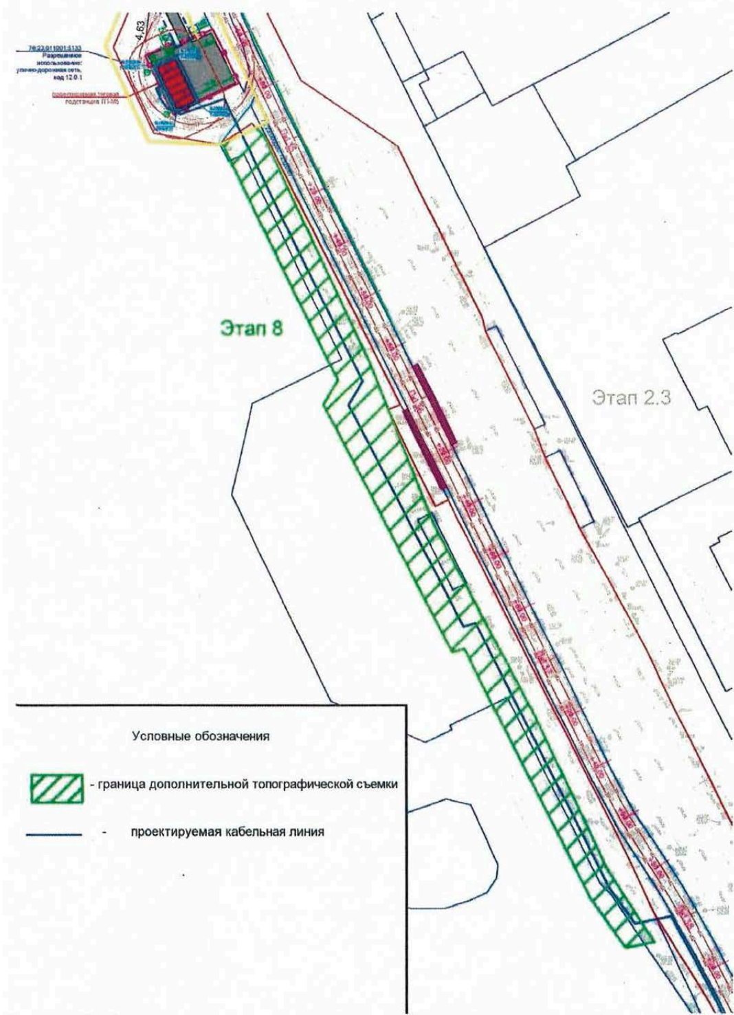
Рисунок 4.2. Схема границ дополнительной топографической съемки для кабельной линии (ПК 135-ПК 138, Этап 2.3)
