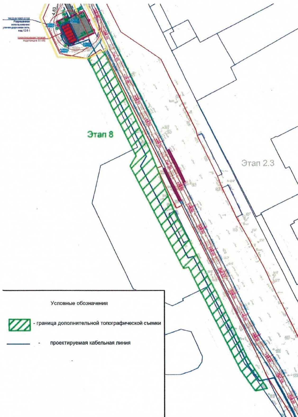
Рисунок 4.2. Схема границ дополнительной топографической съемки для кабельной линии (ПК 135-ПК138, Этап 2.3)
