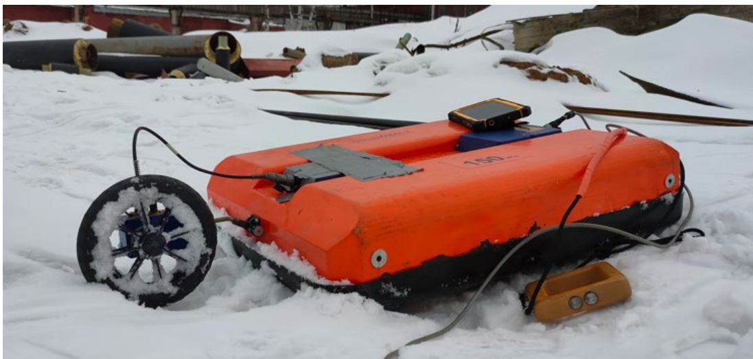
Рисунок 2.1. Комплект Георадара ОКО-3 с антенным блоком 150 МГц
