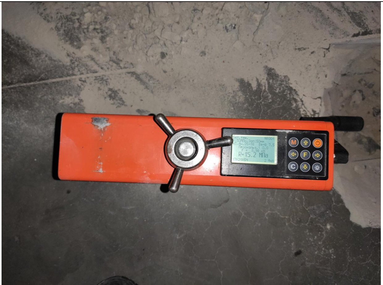
Фото 33. Измерение прочности бетона полов.
