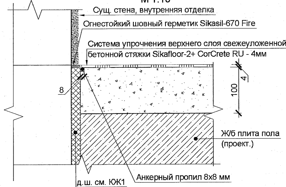
Узел примыкания покрытия пола по системе Sika к существующим стенам (для полов типа 5) М 1:10
