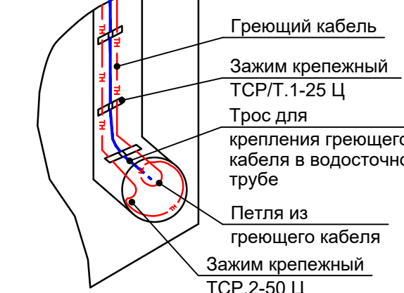
Укладка и крепление греющего кабеля
