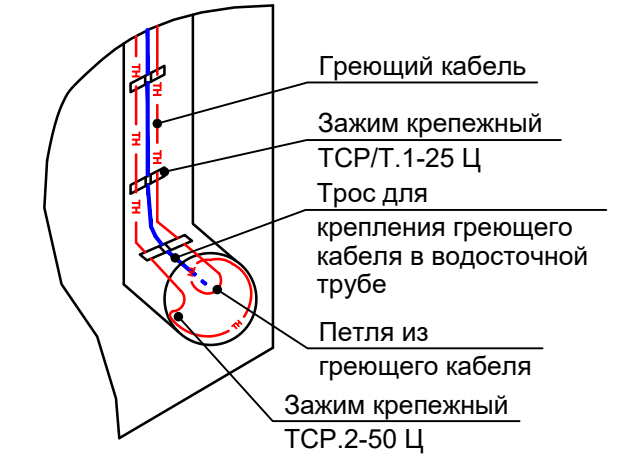
Укладка и крепление греющего кабеля
