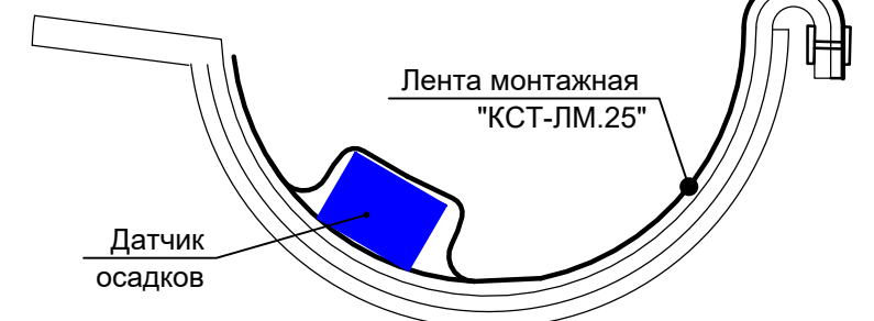
Типовой узел крепления датчика осадков в подвесных лотках
