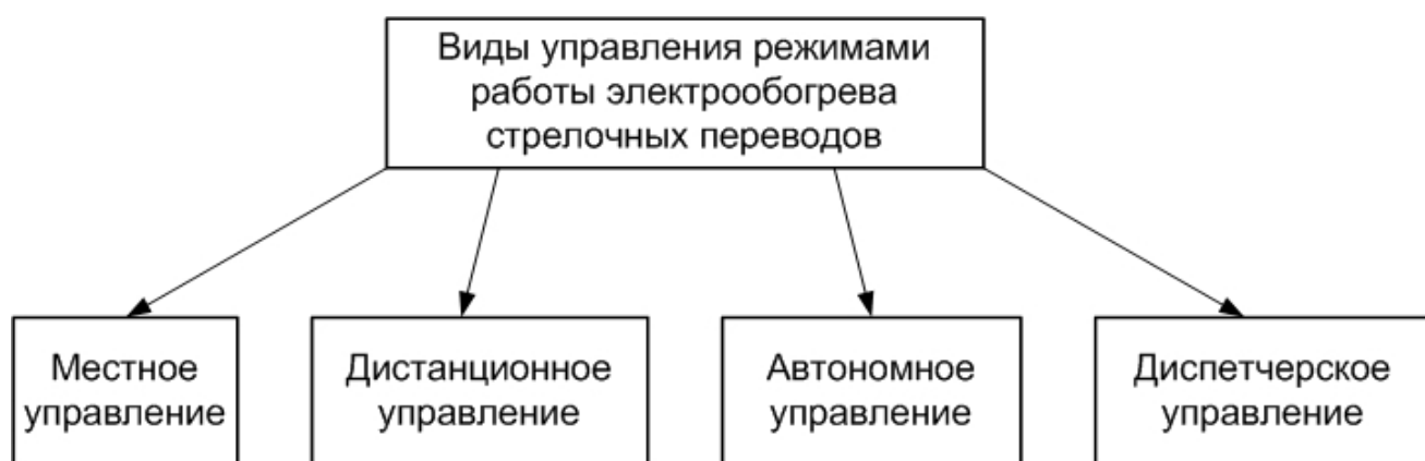
Рисунок 3 — Виды управления режимами обогрева стрелочных переводов
