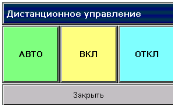
Рисунок 31 – Панель дистанционного управления, отображаемая на экране состояния ШОИТ
