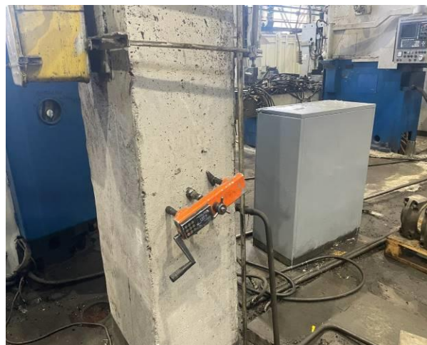
Фото 80. Инструментальные исследования прочности бетона строительных конструкций методом отрывом со скалыванием.
