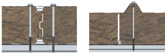
Виды профилирования поверхностей стеновых и кровельных МВ панелей:
