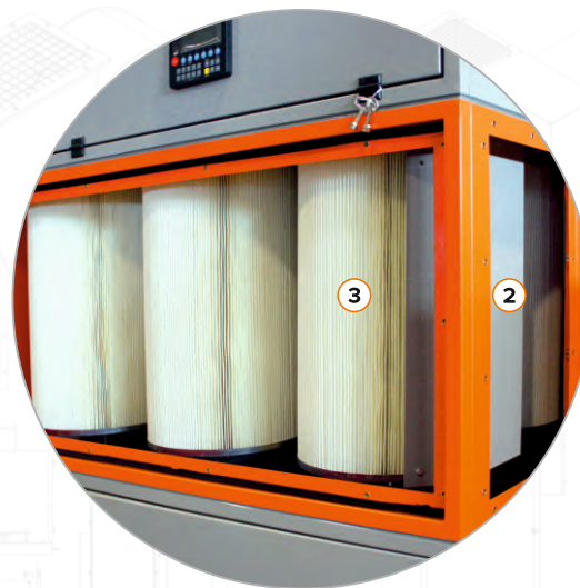
Расположение фильтроэлементов внутри установки.
