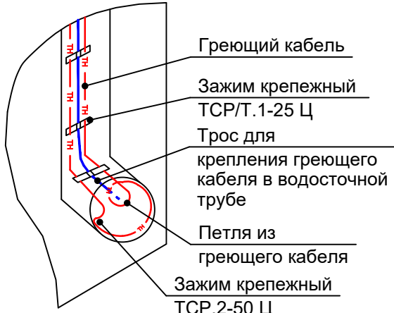
Крепление греющего кабеля в водосточной трубе
