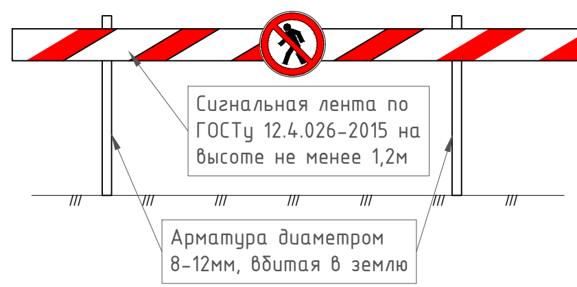
Сигнальное ограждение по контуру опасной зоны
