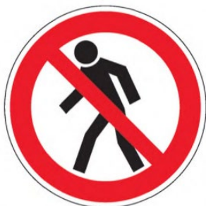
Рис. 15.2.1. Знак Р03. Проход запрещен. Устанавливается у входа в опасные зоны
