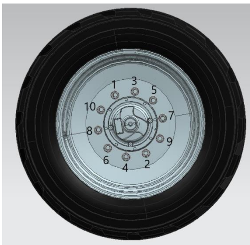
Рис. 4-2 Порядок затяжки крепежной гайки колеса
