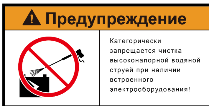
Рис. 1-2 Угроза поражения электрическим током
