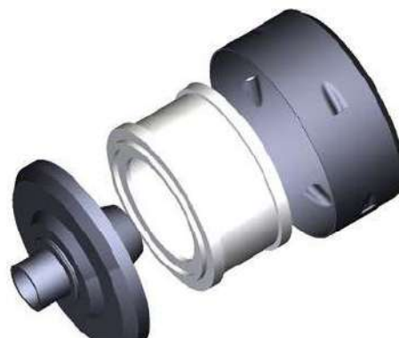
Рисунок 10 Воздушный фильтр, устанавливаемый в компрессорах с мощностью 7,5 - 10 л. с.
