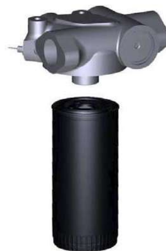
Рисунок 9. Замена масляного фильтра.
