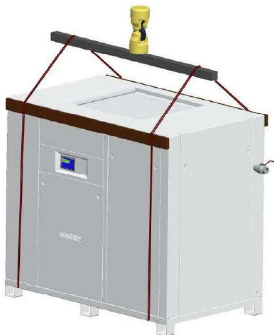
Рис. 19 Транспортировка компрессора DVK 100 с помощью подвески
