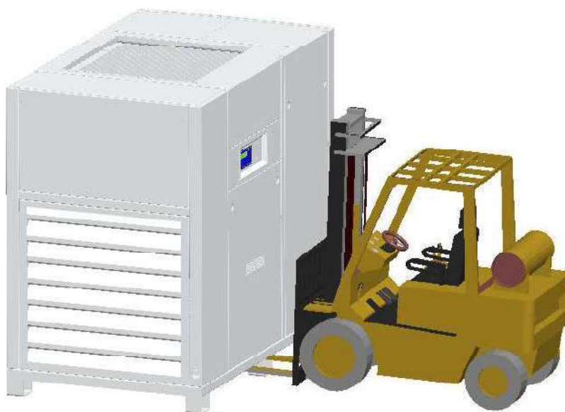
Рис. 16 Транспортировка компрессора DVK 100 с помощью вилочного погрузчика
