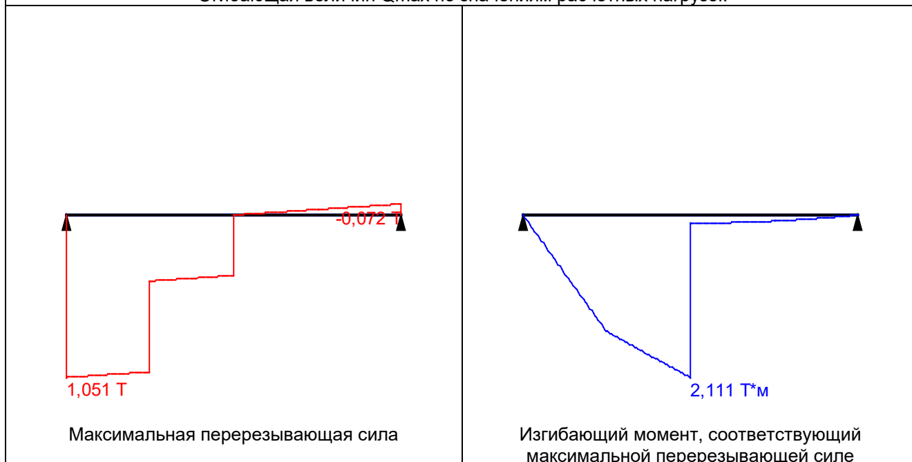
Огибающая величин Q_{\max} по значениям расчетных нагрузок
